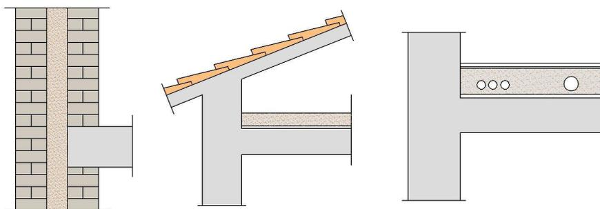
Figura 9 – de aplicação de compósito de cânhamo/metacaulino/cal.
