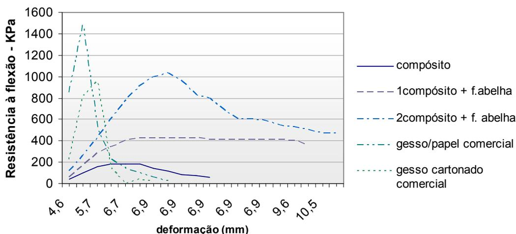
Figura 14 – Comportamento à flexão de diferentes placas.
